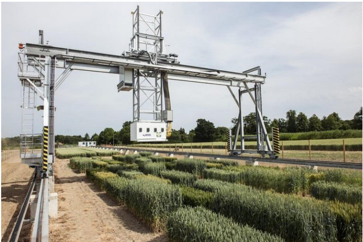
Rothamsted Research - Le réseau numérique de caméras, de scanners laser et de capteurs du "Field Scanalyzer" fournit des données en continu sur les performances des cultures expérimentales...une véritable vitrine pour les blés issus de NTG donc.
